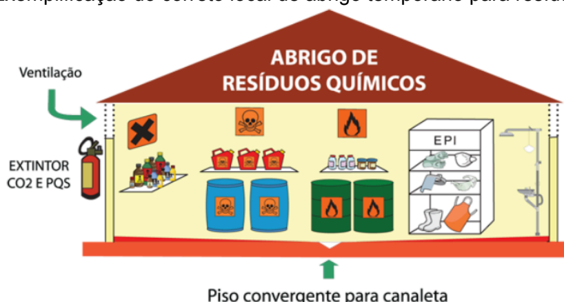
Figura 38: Exemplificação do correto local de abrigo temporário para resíduos químicos.
